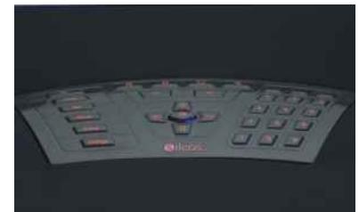
Oben: Geschlossene und lackierte Silikon-Oberfläche mit Hintergrundbeleuchtung.
