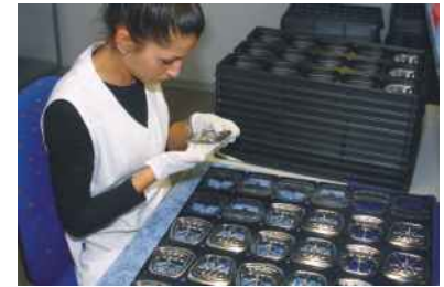
Oben: 100 Prozent Sichtprüfung. Eine Silcos-Mitarbeiterin nimmt die mit wenigen Atomlagen Metall beschichteten Kunststoff-Teile unter die Lupe, die als Zierring und Audi-Emblem (unten) am Lenkrad verbaut werden.
