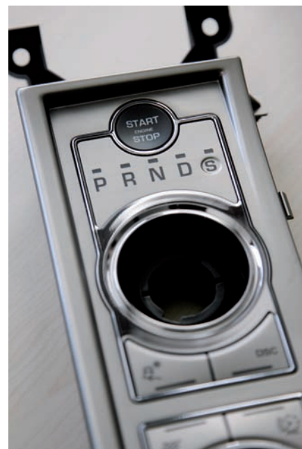
Bild 5. Eine besondere Herausforderung bietet die Entwicklung eines beleuchteten Zierringes für eine Mittelkonsole.
