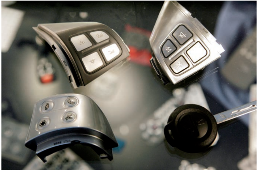
Bild 2. Auch bei Lenkradschaltern kommen Silikonanteile zum Einsatz. Sie müssen auch Angriffen durch Handschweiß und Reibung widerstehen.
