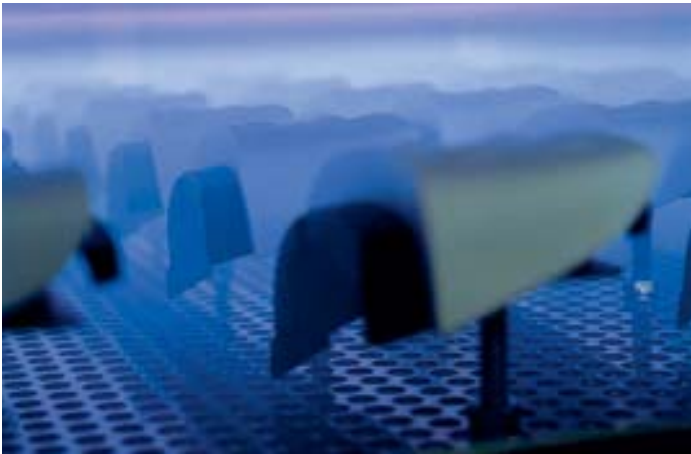
Silikon wird vor der Lackierung einer Behandlung unterzogen, um seine Oberfläche überhaupt erst benetzbar zu machen
